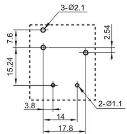
备注: (1) 产品部分外形尺寸未注尺寸公差, 当外形尺寸 $\leq 1\text{mm}$ , 公差为 $\pm 0.2\text{mm}$ ; 当外形尺寸在 $(1 \sim 5)\text{mm}$ 之间时, 公差为 $\pm 0.3\text{mm}$ ; 当外形尺寸 $> 5\text{mm}$ , 公差为 $\pm 0.4\text{mm}$ ;
